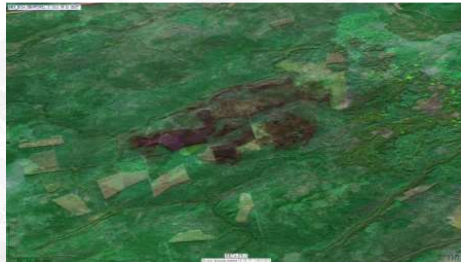
Изображение гары (площади пройденной огнем) на данных прибора MSI (спутники Sentinel 2)
